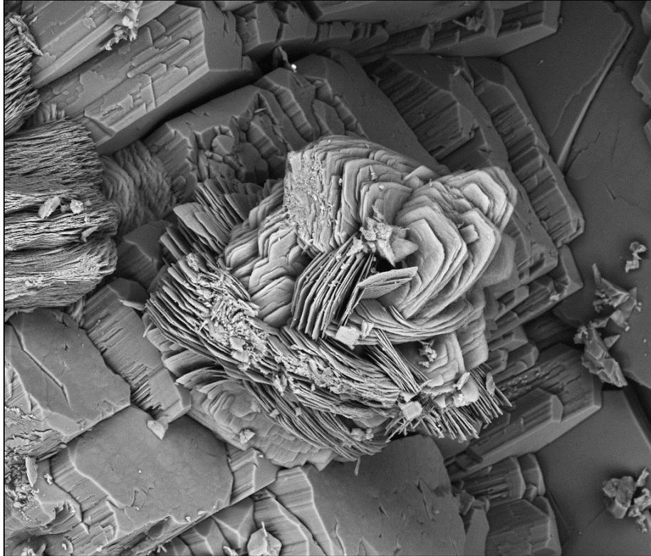
Figura 18: Imagen en BSED de cristales tabulares de jahnsita ( $\text{CaMnFe}$ ) sobre jahnsita ( $\text{CaMnMn}$ ). Encuadre  $200\ \mu\text{m}$ .
