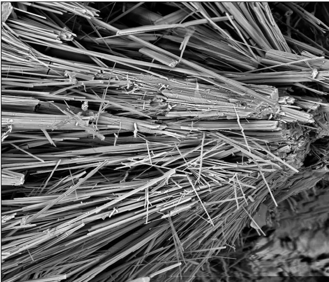
Figura 29: Imagen en modo BSED de nordgaita fibrosa. Encuadre 200  $\mu\text{m}$ .
