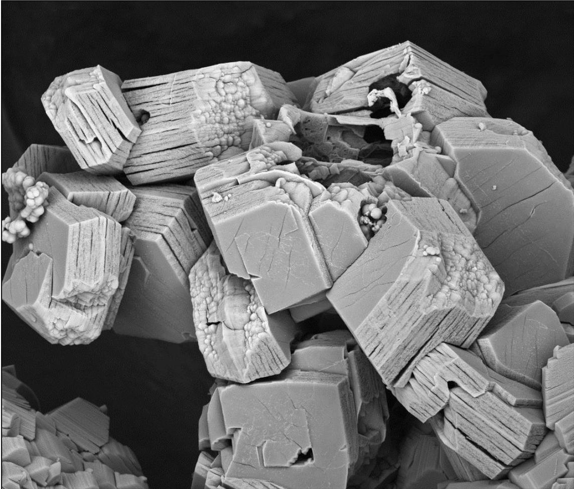
Figura 9: Cristales de benyacarita en modo BSED. Las grietas que se observan, paralelas al plano (010), fueron posiblemente causadas por la deshidratación en la cámara de vacío del SEM. Encuadre 149  $\mu\text{m}$ .
