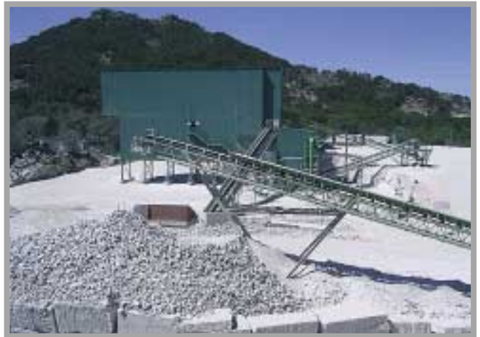
Planta de trituración de "M. Martínez, S.L.". En la nave se encuentra una machacadora giratoria primaria. Foto: C. González, 2004.
