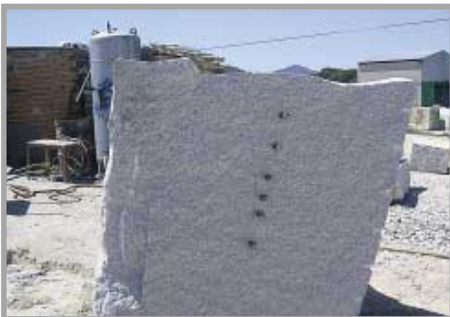
Los canteros conocen perfectamente la ley o "andar" del granito, que es el plano de debilidad por el que la roca abre, y que está en relación con la orientación de los cristales de feldespato y mica. Fotos: C. González, 2004.
