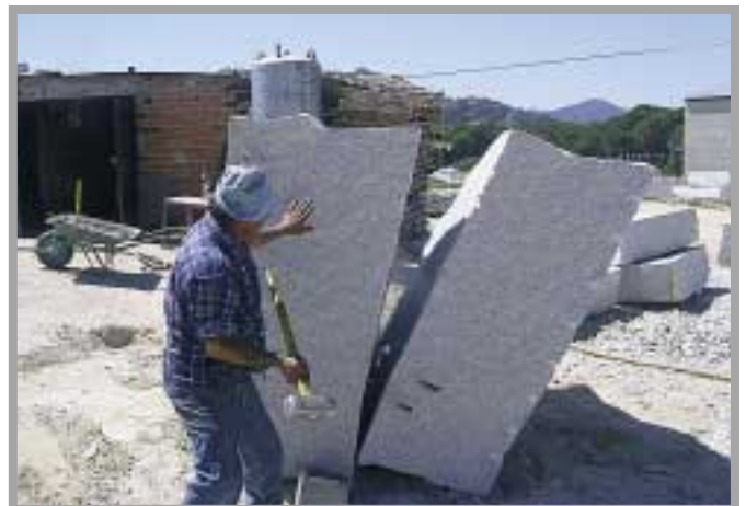
Los canteros conocen perfectamente la ley o "andar" del granito, que es el plano de debilidad por el que la roca abre, y que está en relación con la orientación de los cristales de feldespato y mica. Fotos: C. González, 2004.
