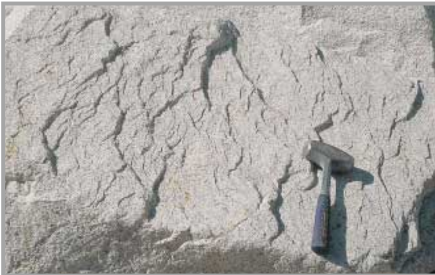
Superficie de fractura donde son perceptibles los "escalones" de falla, dando idea del sentido de desplazamiento. Foto: G. García, 2004.
