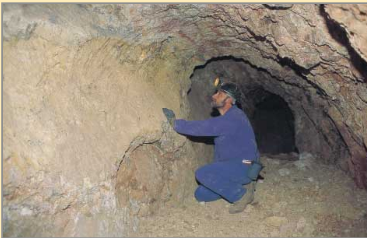
Filón mineralizado de la mina “Las Niñas”, concesión de 12 Ha otorgada en 1868 para beneficio de plomo argentífero. Las arañaduras sobre el filón ponen de manifiesto una explotación muy antigua, por procedimientos completamente manuales. Foto: G. García, 12/2003.
