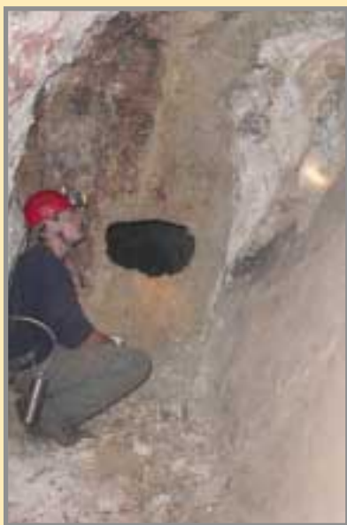
Frente del filón en la mina "Las Niñas". La pared que separa dos paneles de explotación es tan delgada que en este punto aparece rota. Foto: F. Palero, 12/2003.
