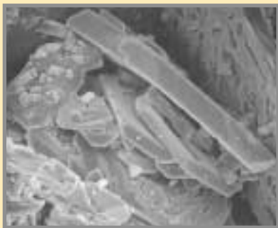
Imagen SEM de alunita tipo I, con caolinita. Foto: Arribas Jr.
