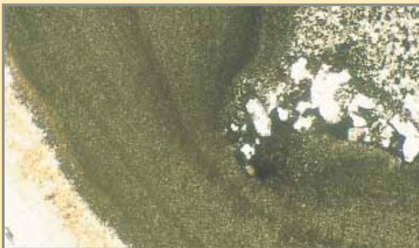
Imagen de microscopio de la casiterita xiloide (bandedo oscuro corroído por el cuarzo microcristalino-jaspe) que acompaña al oro del Filón 340. Foto: A. Arribas.
