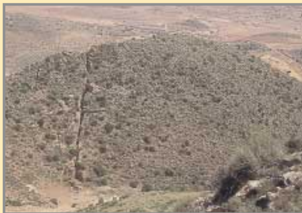
Tajo sobre las estribaciones del Cerro de la Hortichuela, 2 km al norte de Rodalquilar, que corresponde al vaciado del filón "El Triunfo", concesión otorgada en 1922 para beneficio de plomo. Foto: A. Arribas.
