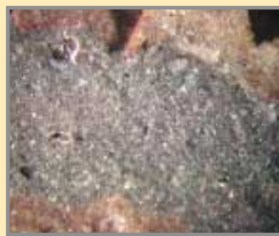
Calcedonia negra con fina dispersión de telururos de oro. Al alterarse, el oro queda libre y se originan teluritos como la rodalquilarita. Colección: A. Arribas.
