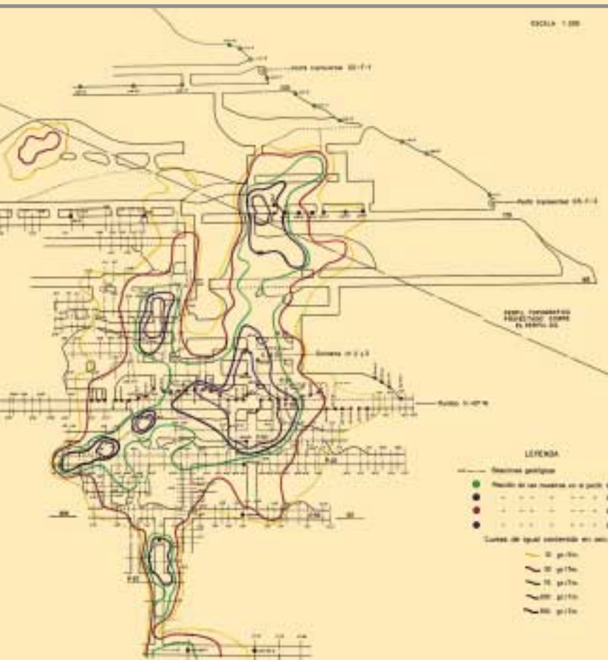
Esquema de isolíneas de contenido en oro de la Estructura 340, la mineralización más rica de Rodalquilar y que no fué detectada por los ingleses en los 2 socavones superiores, aunque estuvieron muy cerca de descubrirla. Figura: Adaro.
