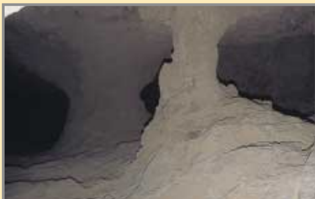
Una vista picada del hueco de explotación del Filón 340, el más rico en oro de Rodalquilar, donde se pueden observar llaves sobre filón, en las que sin dificultad se localiza el oro visible. Foto: G. García, 12/2003.
