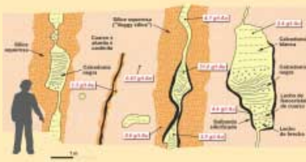
Esquema-representación de la mineralización del Dique 2 del Cerro del Cinto, según Arribas Jr.
