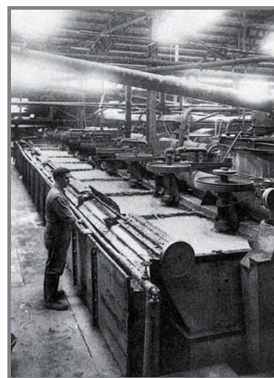
Celdas de flotación en el lavadero de Torres. Al agotarse las calaminas, fue preciso buscar el aprovechamiento de los sulfuros. Fuente: RCAM.
