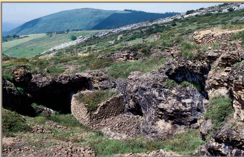
Acceso a la zona de la mina Isidra desde los niveles superiores de la explotación. Véase el techo de calizas blancas y las obras mineras de mampostería en la zona dolomitizada y mineralizada. Foto: G. García, 8/2000.
