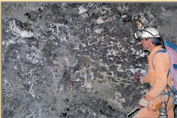
Frente mineralizado de alta ley (blenda-galena) próximo a la rampa en el 4º nivel de la mina La Curre, con el aspecto brechoide característico de esta parte del yacimiento. Foto: F. Palero, 11/1998.
