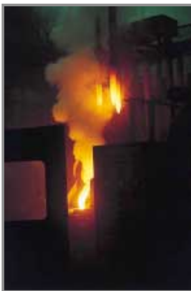
Horno eléctrico de la planta de oro de Riotinto recién iniciada la colada de Bullion. Foto: Fernando Palero.
