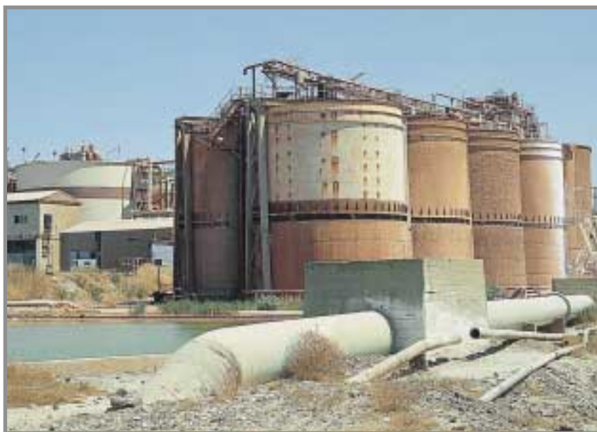
Tanques reactores o "Pachucas" para la cianuración de la pulpa procedente de la molienda del gossan de Cerro Colorado (Riotinto). Agosto de 1998. Foto: Gonzalo García.
