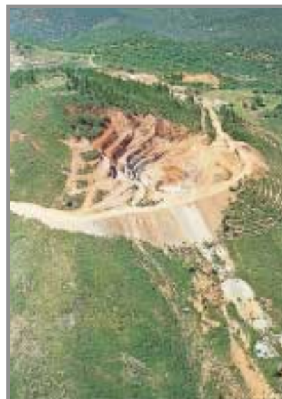
Vista aérea de la mina Castillo de Buitrón (Huelva), en el año 1993. En lo alto del cerro se observa la corta mediante la que se explotó la Masa Poniente (ampliada por Riotinto posteriormente en busca de gossan, como se puede ver) y los socavones de los tres niveles de explotación que se realizaron para la Masa Levante. Foto: Azimut S.A.
