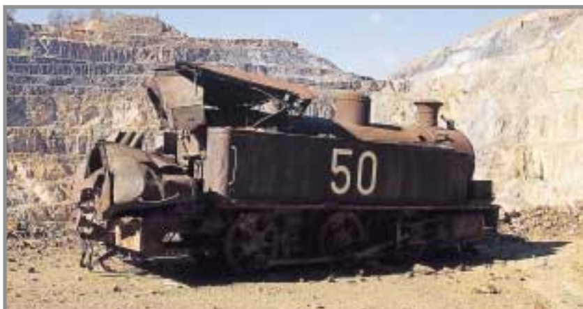
Locomotora de vapor, clase I. Estas locomotoras, conocidas con el sobrenombre de "chatas" porque el tejadillo de su cabina era muy bajo para permitir el paso por túneles, fueron utilizadas (h. 1900) masivamente para el transporte de mineral y estéril durante la ampliación de Corta Atalaya (Riotinto). La de la foto es la n° 50, y quedó atrapada por un hundimiento en un ramal del Piso 16. Durante los trabajos de expansión hacia el Norte de la corta, fue desenterrada y colocada en su actual emplazamiento, el banco del 15 Piso.
