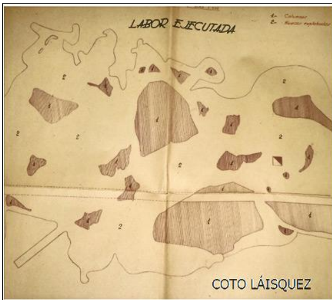
Figura 11: Plano de explotación del Coto en los años 50 1-Pilares o esterilidades; 2-Zonas explotadas
