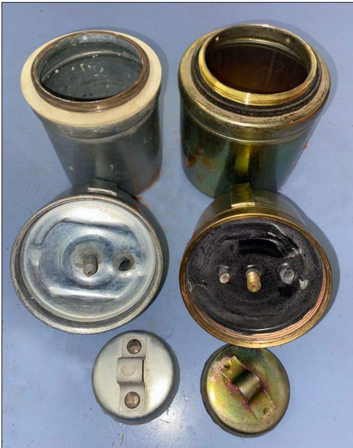
Figura 33: Despiece comparativo de las lámparas (Col. y fot. A. Gómez)
